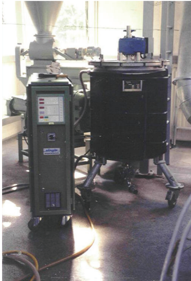
Abbildung 3: Anlage zur enzymatischen Aufbereitung des Fermentationssubstrats.
