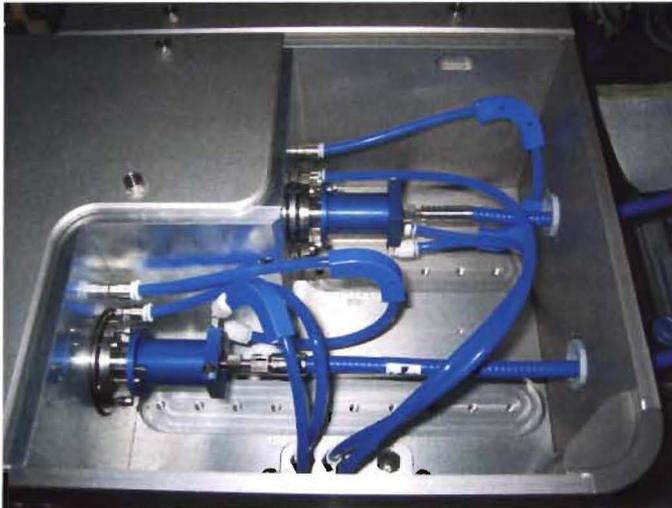
**Abbildung 13: Einkoppeloptiken mit angeschlossener Kühlwasserzufuhr und Lichtleitkabeln**
