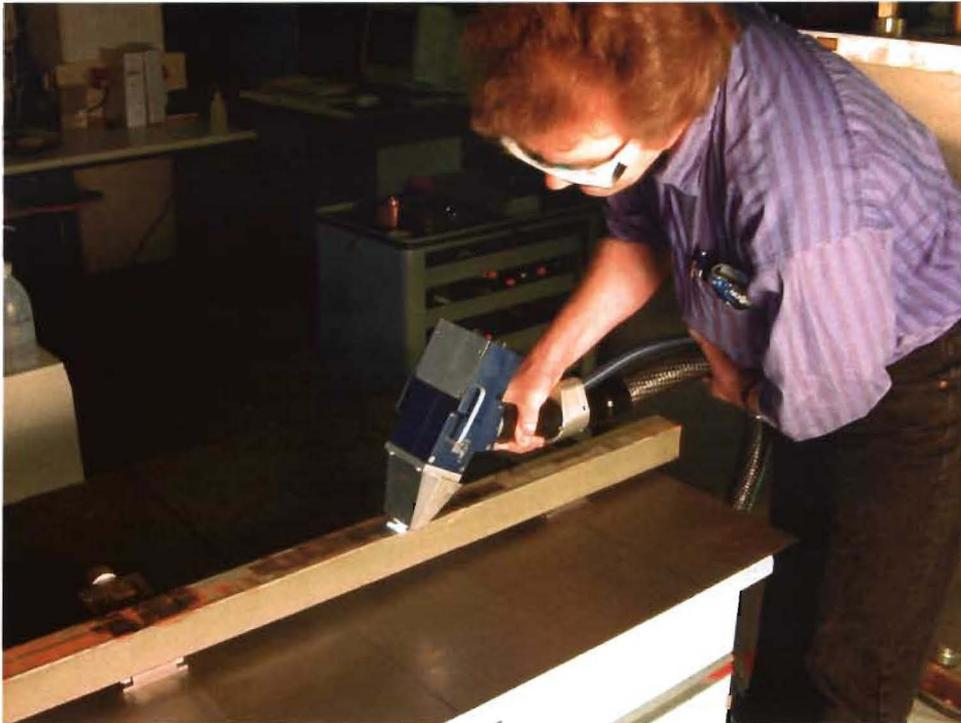
**Abbildung 16: Entschichten von Stahlprofilen (Teile eines Hochspannungsmastes) mit dem neuen High-Power-Lasersystem**
