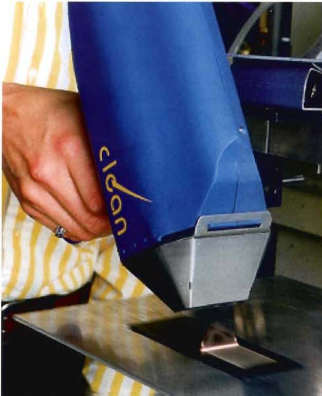
**Abbildung 1: Abtragen von Deckschichten mit Laserstrahlung**
