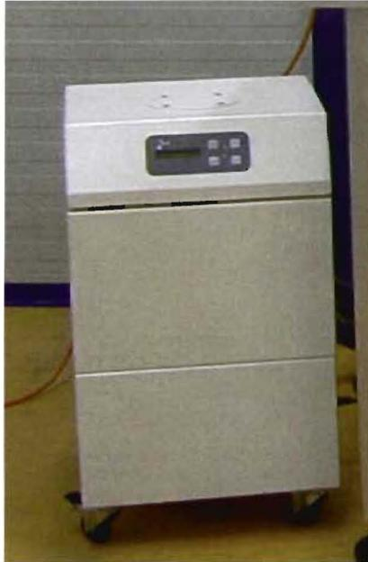
**Abbildung 4: Kompaktes Absaugsystem mit integriertem mehrstufigem Filtersystem und Hochvakuumturbine für Entschichtungsapplikationen mit geringen Emissionen**
