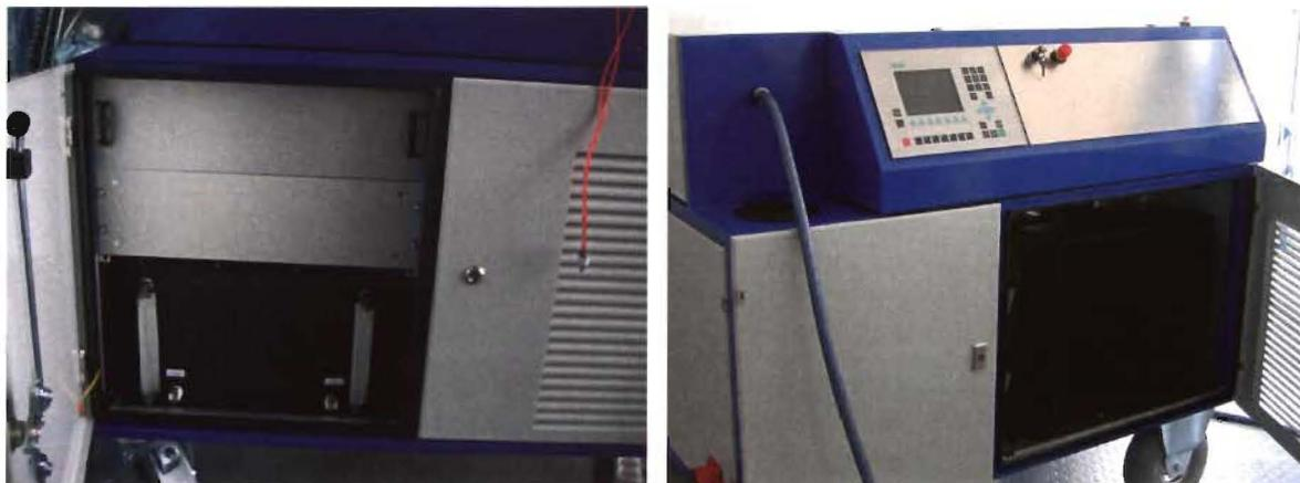
**Abbildung 9: Montagebereich für 19“ Zusatzmodule des Lasersystems**
