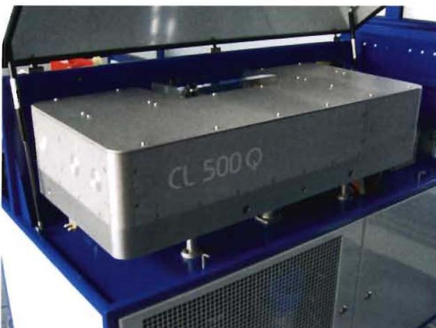
**Abbildung 7: Geöffnete Resonatorhaube mit Laserstrahlquelle**
