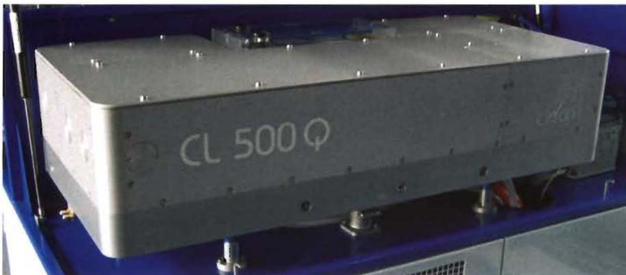
**Abbildung 10: High-Power Laser-Resonator mit  $P_m > 500$ Watt Laserleistung**
