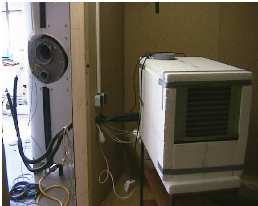
Bild 90 Versuchsaufbau der Luft/Wasser-Wärmepumpe – Laborversuch IGS
