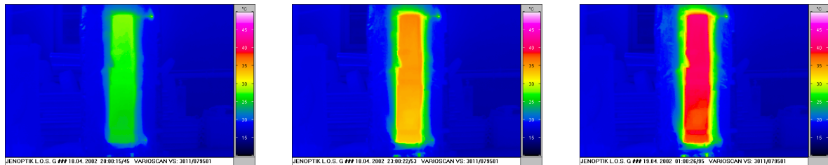
Beladung eines Schichtenspeichers ( V = 475 l) mit 350 l/h, Zeitschritte 2 bis 3 h
