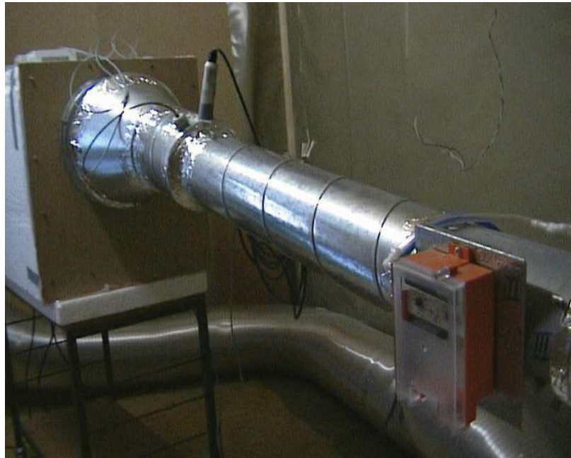
Bild 89 Verdampfer als Spiralrohr mit aufgelötetem Kupferrohr
