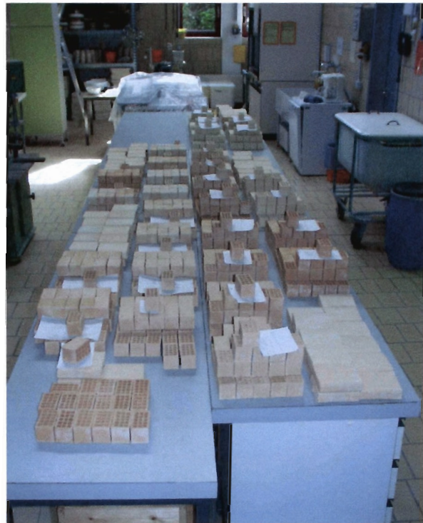
Abb. 15: Labor-Ziegel nach dem keramischen Brand
