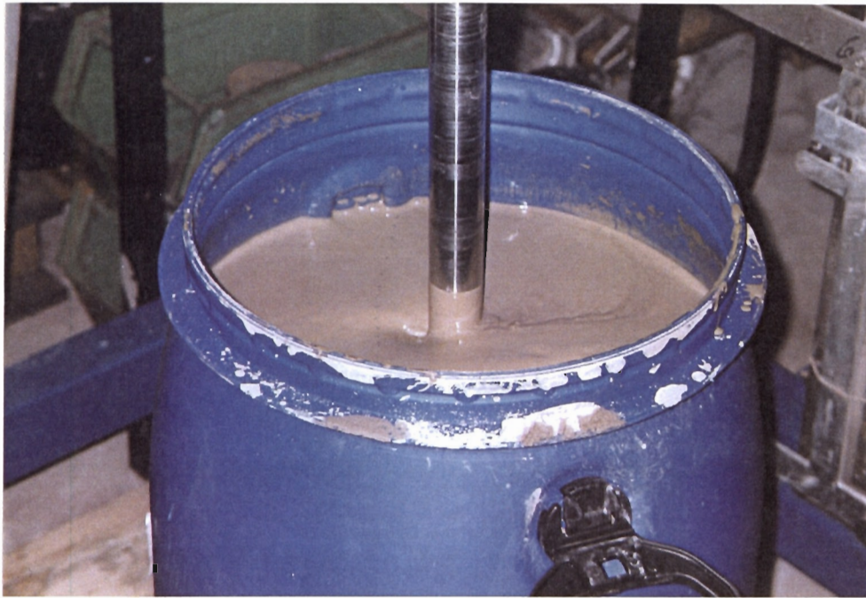
Abb.1 Aufrühren der Suspension und Homogenisierung Suspension/Filterhilfe im Spannringsdeckelfaß
