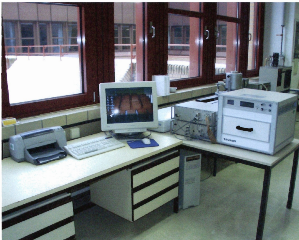
Abb. 16: Neuer Messplatz für die Bestimmung der Scherben-Wärmeleitfähigkeit \lambda
