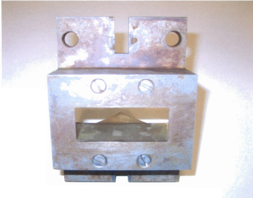
Abb. 7: Extruder-Mundstück ohne Kerneinsatz für die Herstellung von Vollziegeln
