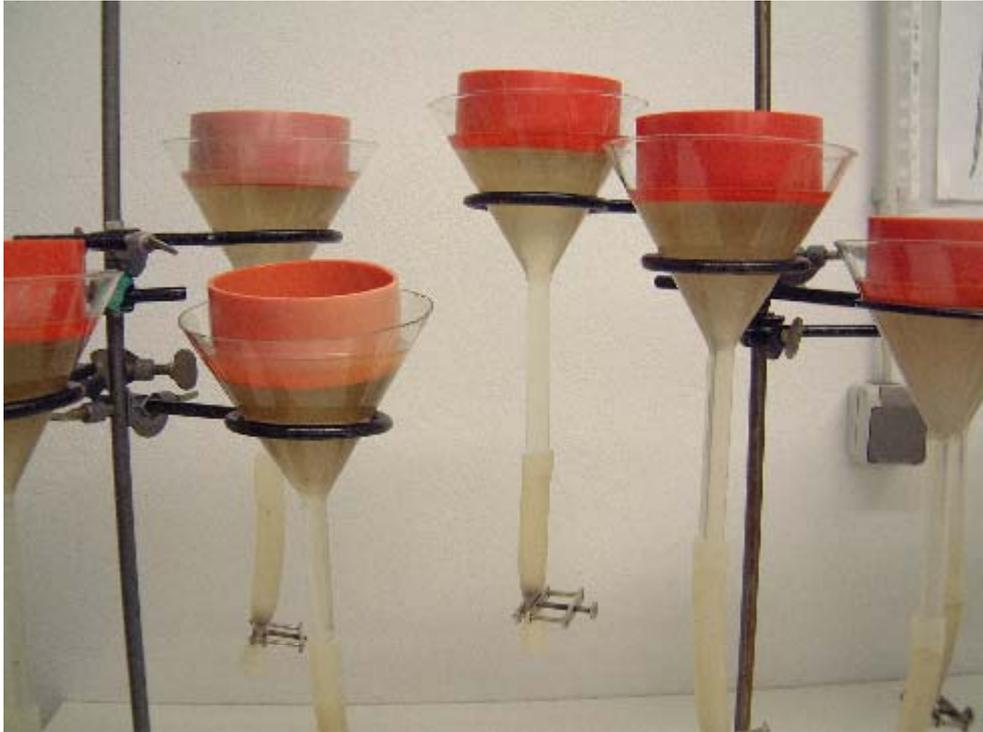
Abbildung V - 3: Versuchsaufbau zur Extraktion der Nematoden aus den Bodenproben
