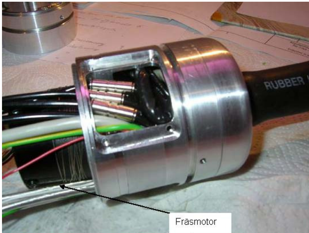
5: Fräsmotor im verkabelten Antriebsmodul
