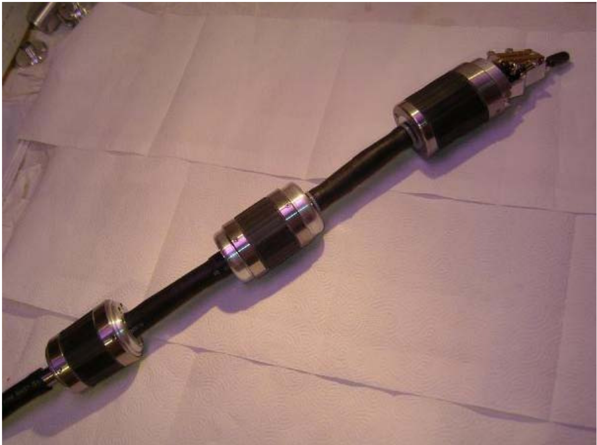
Bild 1: Prototyp des Satellitenroboters
