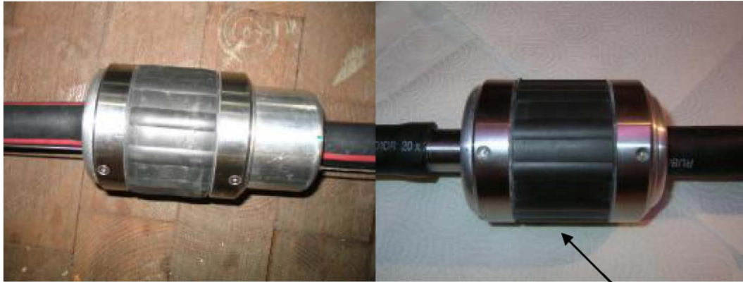
Bild 7: Vorschubmodul ausgefahren und eingefahren
