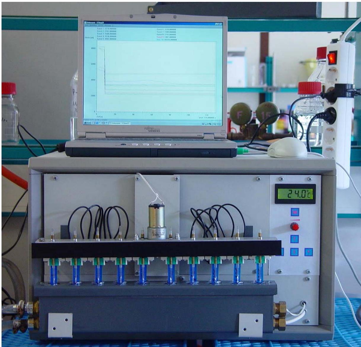
**Abbildung 5: Mehrkanalmessgerät für Biosensoruntersuchungen**
