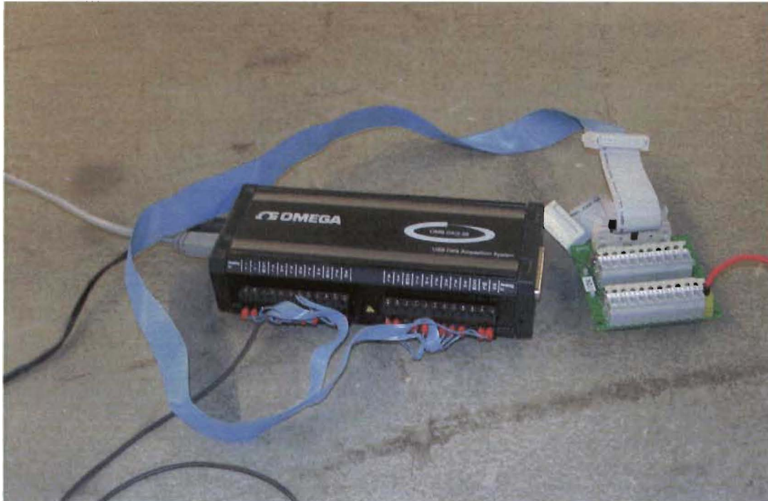
Abbildung 2: Mobiles Messsystem OMB-DAQ-56 von OMEGA
