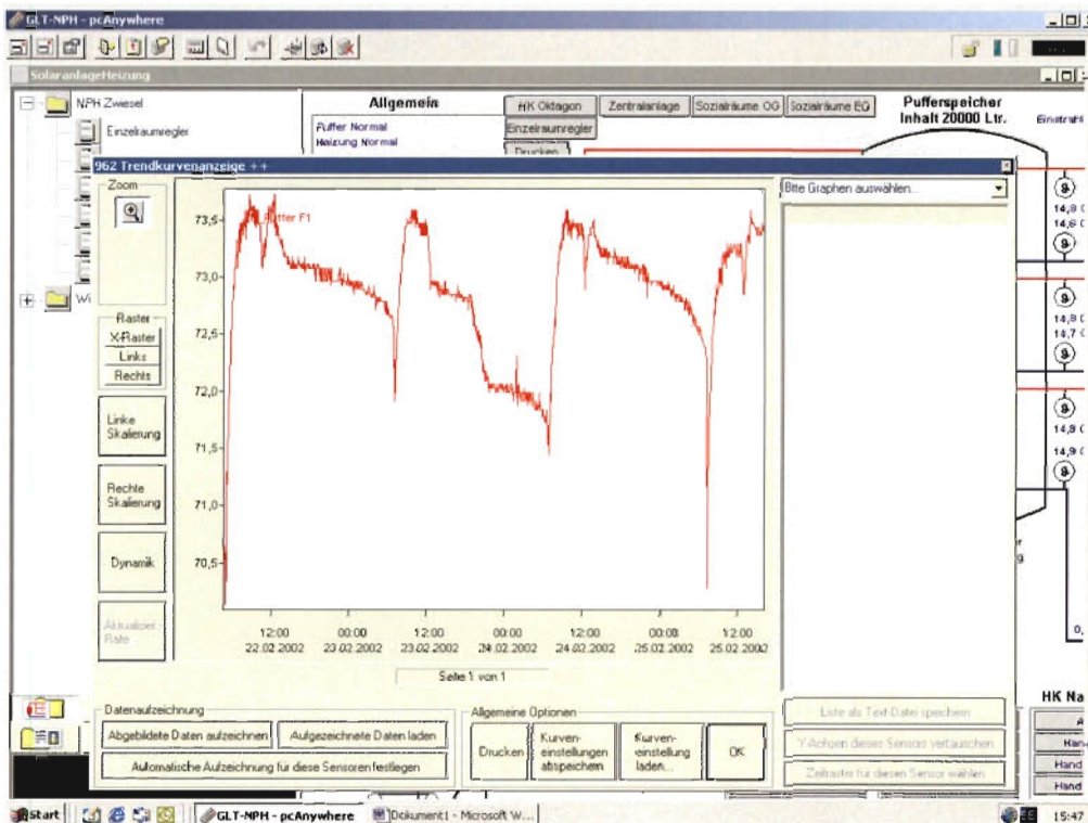
Abb. 51: Bildschirmanzeige am Gebäudeleittechnikrechner für Datenaufzeichnung Puffertemperatur
