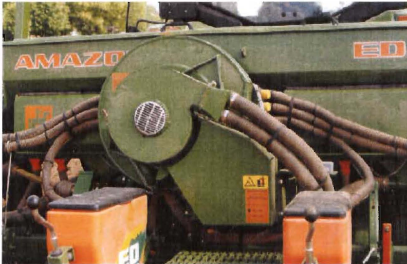
Abb. 4-2: Gebläse des Einzelkornsägeräts
