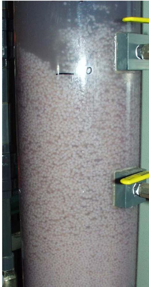
**Abb. 2-10: Nahaufnahme Denitrifikationsreaktor-PCL-Fließbett**
