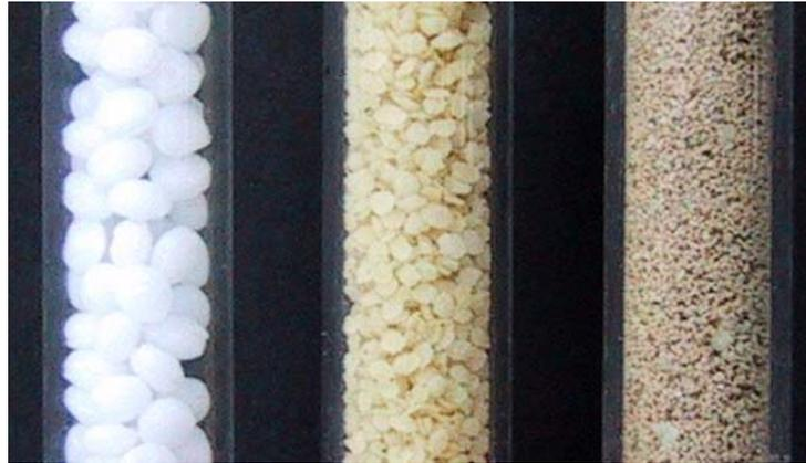
**Abb. 3-35: PCL-Granulat nach 381 d Betriebsdauer: links neues PCL, Mitte: Restgranulat, Säule rechts: Restgranulat, Granulatabscheider (mit anhaftender Biomasse)**
