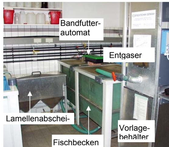
**Abb. 2-6: Fischbecken und Lamellenabscheider**
