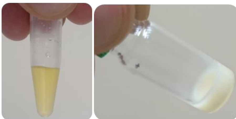
Abbildung 20. Isolierte 6-Hydroxyhexansäure hergestellt aus Cyclohexanol über die lineare Enzymkaskade nach Entfernung des Extraktionsmittels (links). Polymerisierter Rückstand (rechts).
