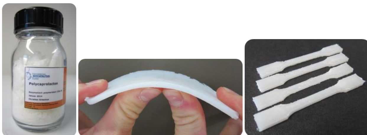
Abbildung 21. Polycaprolacton im präparativen Maßstab und daraus hergestellte Zugstäbe. Die Polymerisation von \epsilon -Caprolacton erfolgte enzymatisch.
