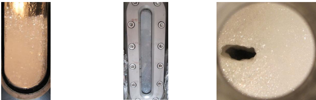
Abb. 1-4: Schaumbildung und –Ausbreitung auf der Mediumsoberfläche im 300 L-Fermenter (50 L Arbeitsvolumen)
