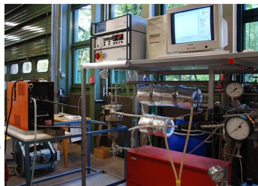
**Abb. 7:** Fließbild und Ansicht der Technikumsanlage (Festbettautoklav 2 L)
