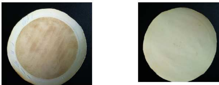
Abb. 22: Vergleich des Foulings von Membranen verschiedener Hersteller nach der Nanofiltration. links: Nadir UC005, 5 mL Permeat, rechts: DMS, Typ DK NF, 150 mL Permeat
