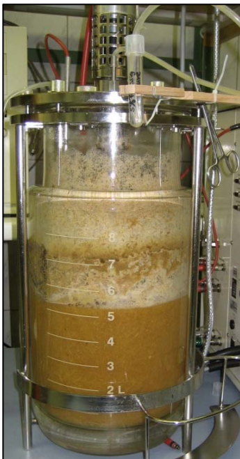
Abb. 10: Produktion größerer Mengen lignocellulytischer Enzyme durch X. polymorpha im 10-Liter-Rührkesselreaktor (links) und im Festsubstrat (200 g Strohkulturen, rechts)
