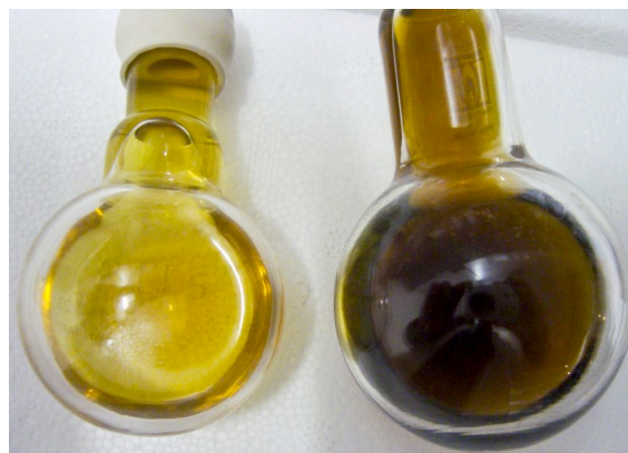
Abbildung 45: Dieselbe alkalische Kaffeesäure-Lösung aufgeteilt in zwei Kolben. Der linke wurde durch Vakuum entgast und mit Stickstoff gespült, der Rechte wurde nicht behandelt.
