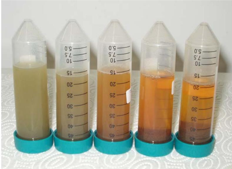
**Abb. 15:** Verfärbung des Substrats nach der thermischen Behandlung von einprozentiger Roggensilage-Suspension im kontinuierlichen Betrieb bei 100 bar und 2,1...2,7 min für verschiedene Temperaturen; v.l.n.r.: 190, 210, 250, 270, 290°C
