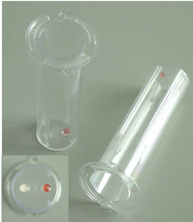
Abbildung 3.2: mL-Einwegbioreaktoren mit am Boden immobilisierten Sensoren
