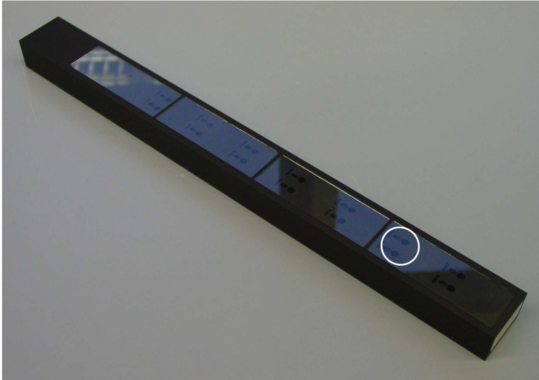
Abbildung 3.3: Sensorblock mit LEDs und Photodioden zur online Messung von pH und pO 2 ; der Kreis markiert die Position eines von 8 Reaktoren
