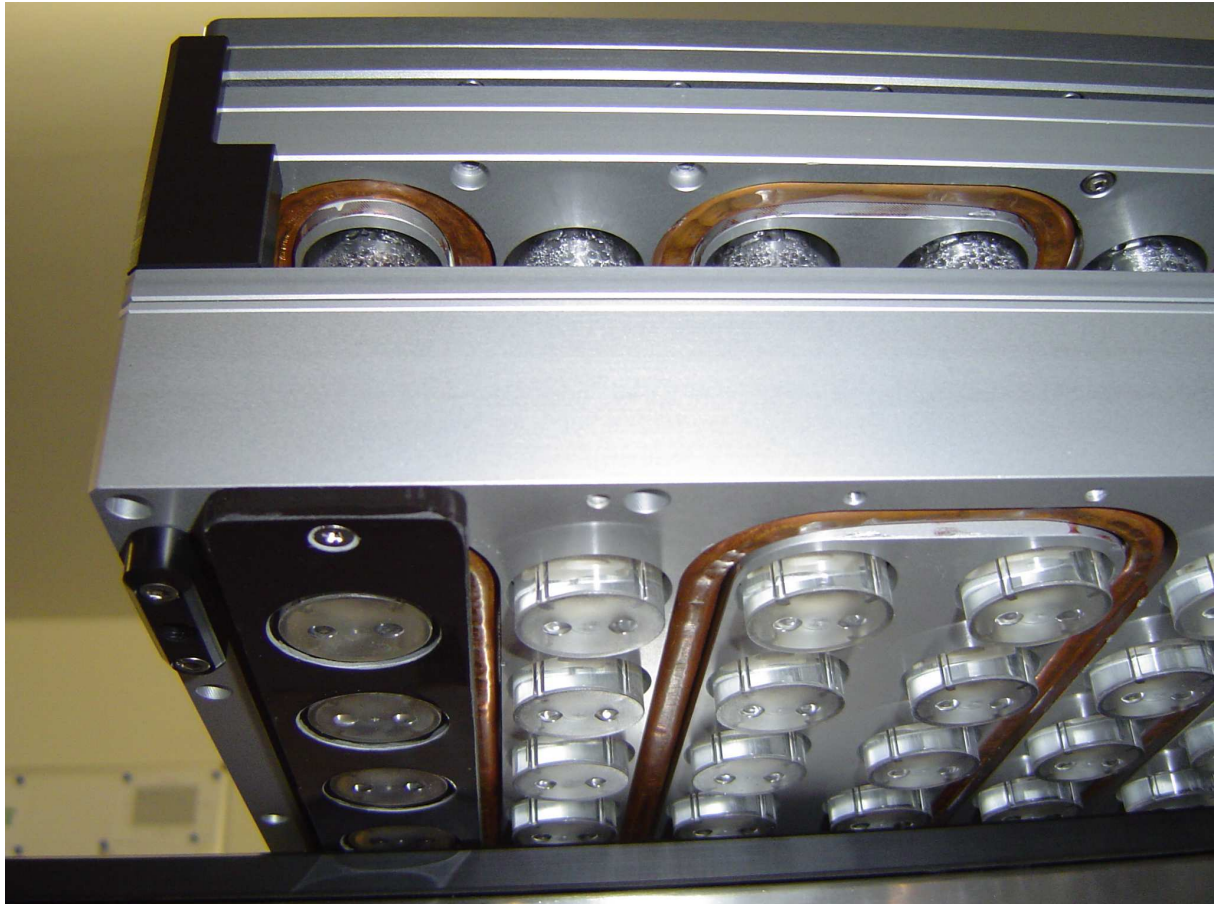
Abbildung 4.8: Bioreaktorblock mit einer von sechs Hallelement-Messplatten (links)
