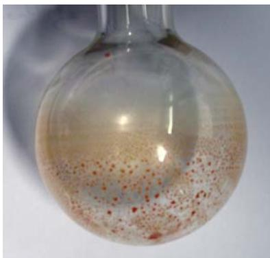
**Abbildung 37:** Produkt der Reduktion des EMC Substrates A133 nach der Destillation
