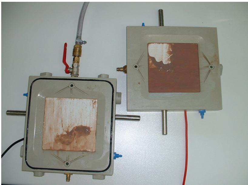
Abbildung 8: Vergleich der Kathoden (links)- und Anodenseite (rechts) der Filterkammer nach einer Elektrofiltration von *Bacillus licheniformis*
