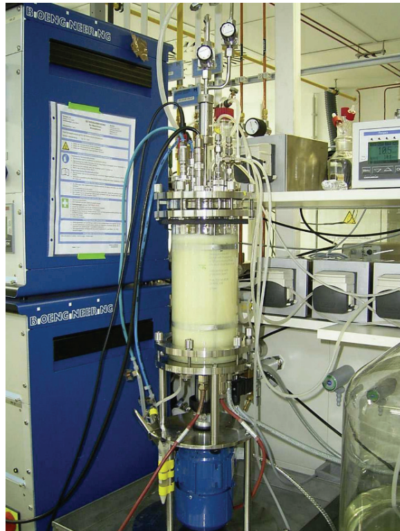
Abbildung 26. Versuchsaufbau zur kontinuierlichen Kultivation mit im Reaktor integrierten Monokanalrohrmembranen.
