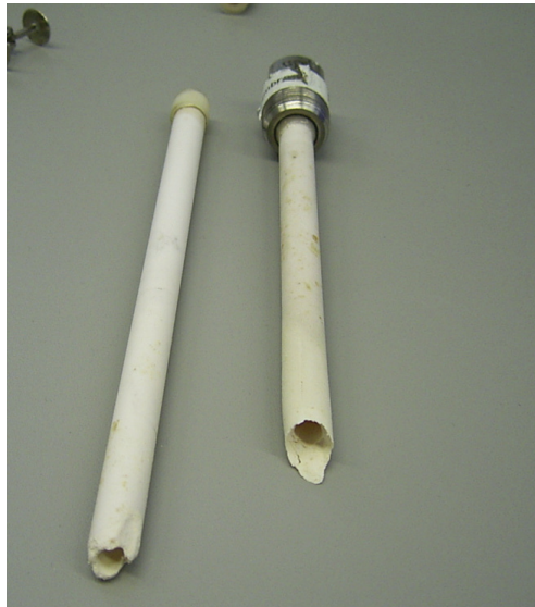
Abbildung 27. Gebrochene feinporige Keramikmembran (1,2 \mu\text{m} Porendurchmesser).
