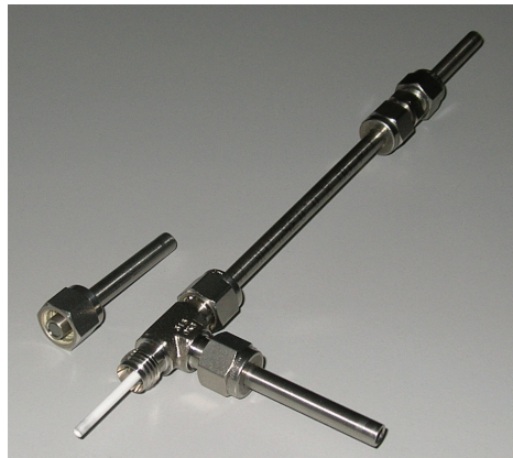
Abbildung 16. Einzelfasermembranmodul aus Edelstahl für die Charakterisierung der keramischen Hohlfasermembranen mittels Bubble-Point- und Flowpore-Analyse.
