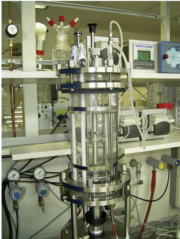
Abbildung 26. Versuchsaufbau zur kontinuierlichen Kultivation mit im Reaktor integrierten Monokanalrohrmembranen.
