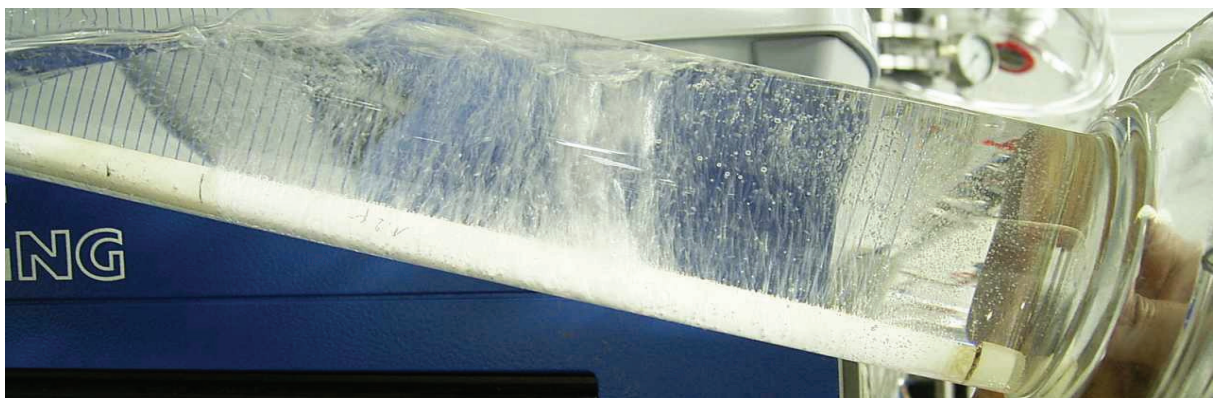
Abbildung 28. Begasungstests mit grobporigen (6 \mu\text{m} ; A, B) und feinporigen (1,2 \mu\text{m} ; C, D) Membranen nach deren Einsatz in kontinuierlichen Kultivationen während 150-170 h. (A), Begasungsrate 0,2 NI/min; (B, C, D), Begasungsrate 2 NI/min.
