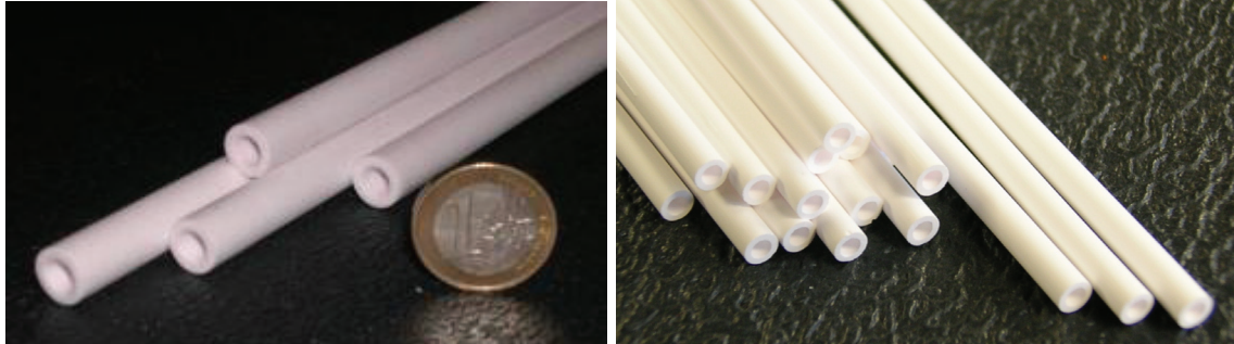
Abbildung 18. Photos der keramischen Membranen zur Begasung. Links: Monokanalrohr. Rechts: Keramische Hohlfasern.
