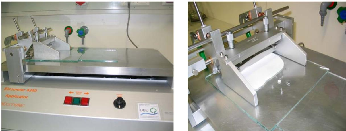
**Abb. 4:** Schienenraker. (links: Seitenansicht und rechts Draufsicht mit Silikon-glucosemischung)
