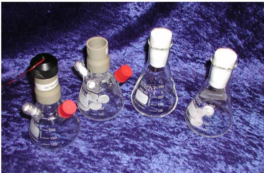
**Abb. 1:** Vergleich der Batch und Fed-batch-Kolben. 250-mL-Erlenmeyerkolben links in Modifikation mit Zu- und Abluftstutzen sowie Animpfstutzen für die RAMOS-Technologie zur Bestimmung der Atmungsraten und rechts als Standard für offline Schüttelkolbenexperimente bzw. als Probenkolben. Die Fed-Batch-Kolben enthalten z.B. vier weiße Silikonelastomerdisk.
