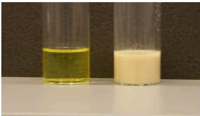
Abb.24: Vergleich der feststofffreien, filtrierten Lösung und der Biomasse.
