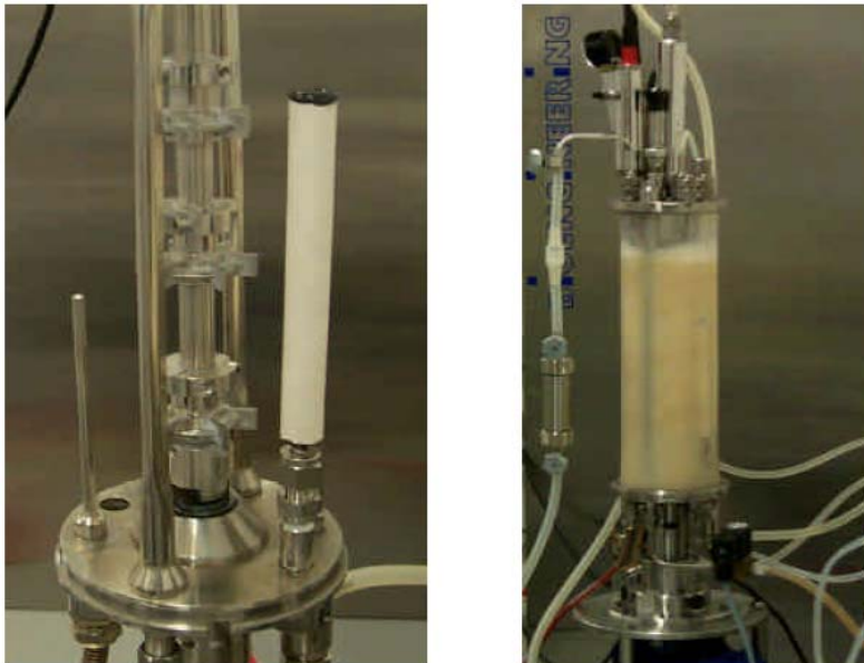
Abb.23: Installierte Monokanalmembran in einem Laborfermenter mit einem Arbeitsvolumen von 1-L.
