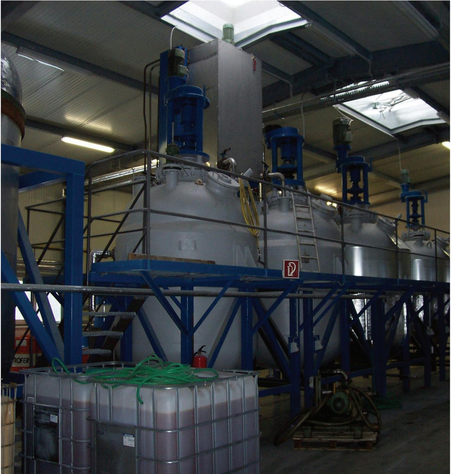
**Abb. 2:** Rührreaktoren der Fa. Greibo-Chemie in Velten
