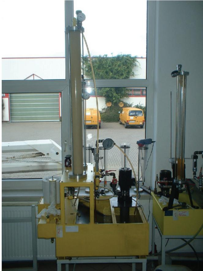
**Abb. 12: Versuchsanlage zur Filtrierung**
