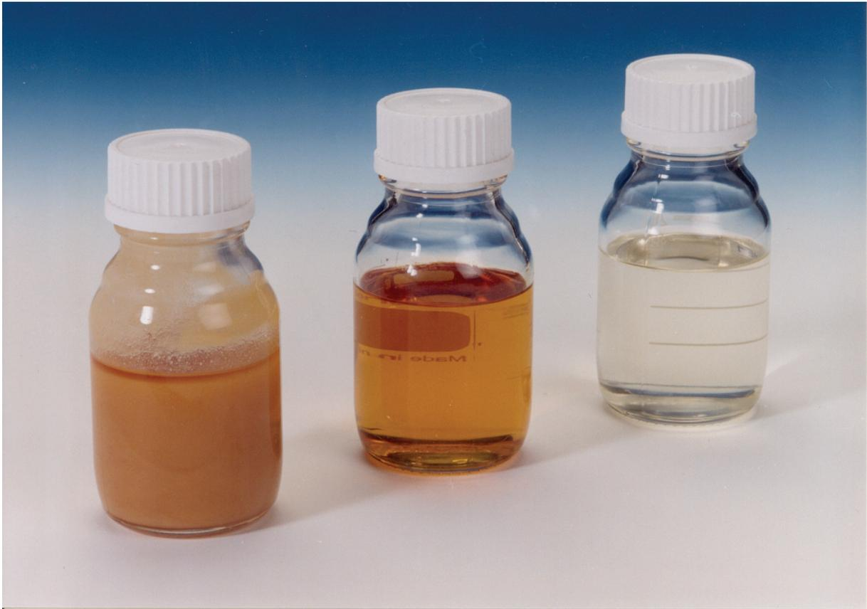
**Abb. 6: Altfett (links), ungereinigter (Mitte) und gereinigter Altfettester (rechts)**
