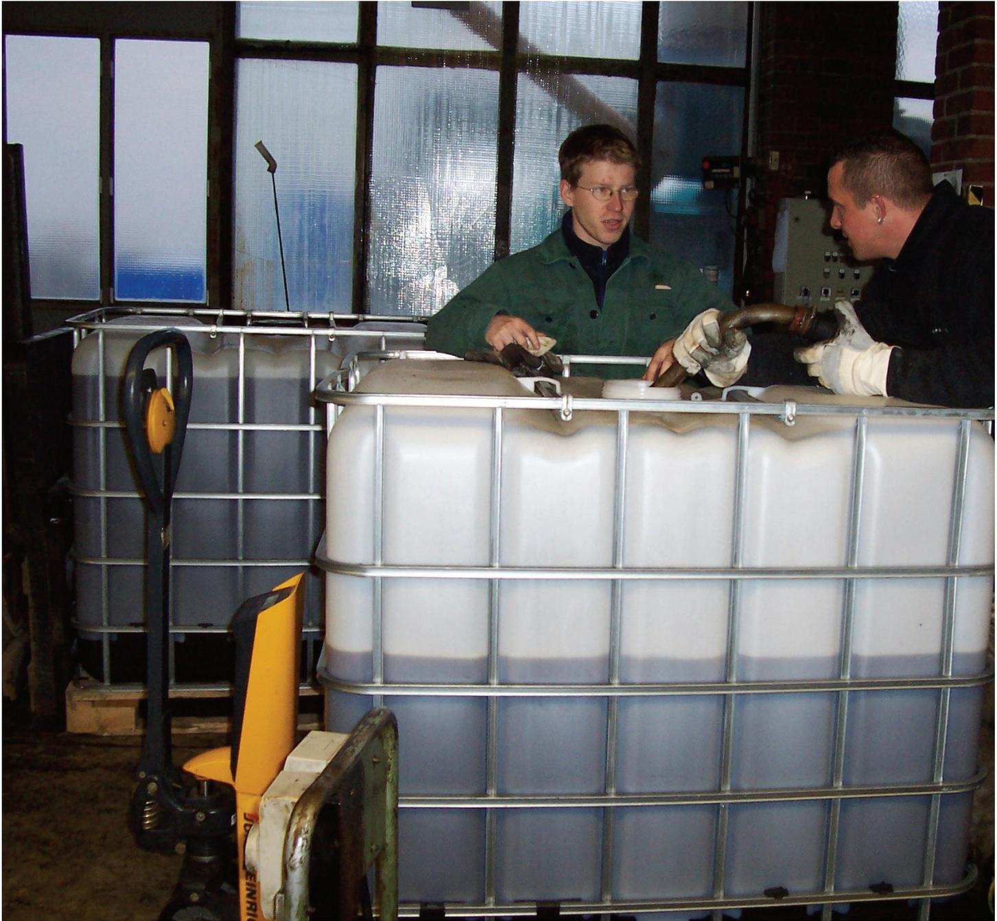
**Abb. 11: Abfüllen des Esteröls in Transportbehälter**
