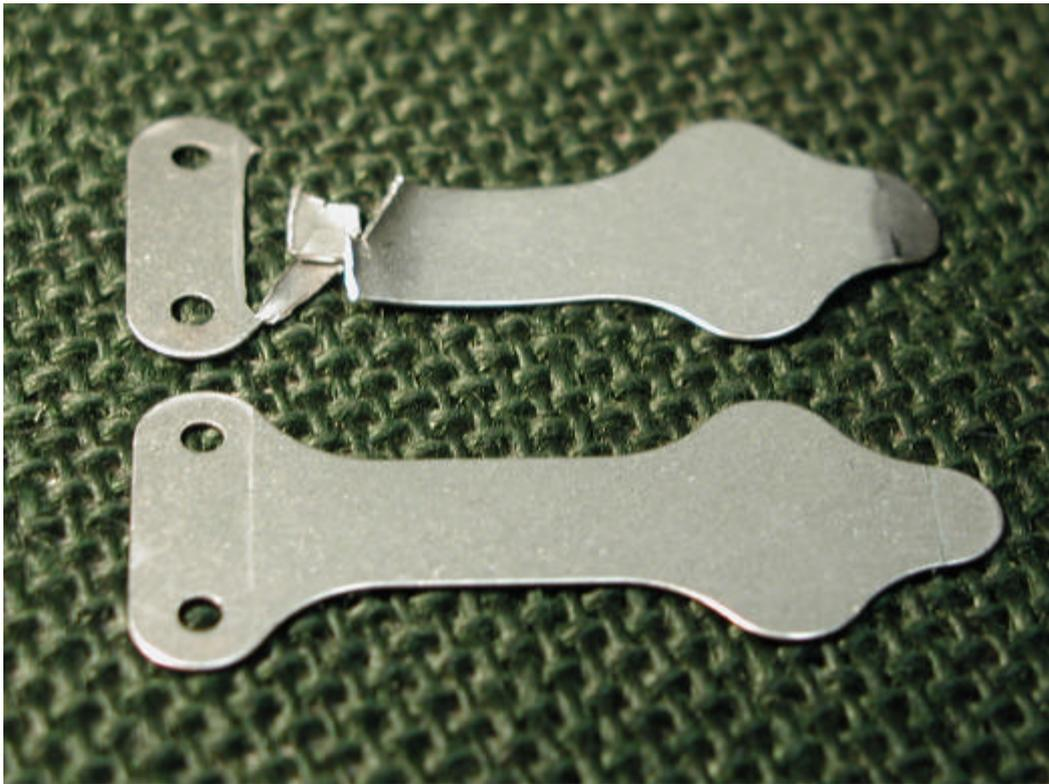
Abb. 2.16: Saugventile Version 3b mit gebrochener Lamelle nach 44 h Betriebsstunden
