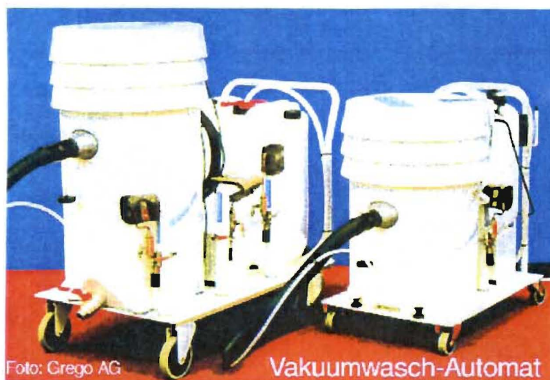
Abbildung 1: Gerätetechnik für das Vakuum-Waschverfahren
