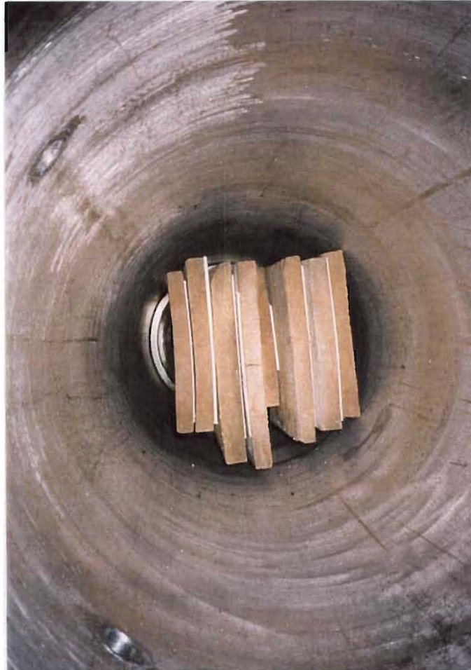
Bild 5: Blick in den mit kontaminierten Brettern befüllten Extraktor
