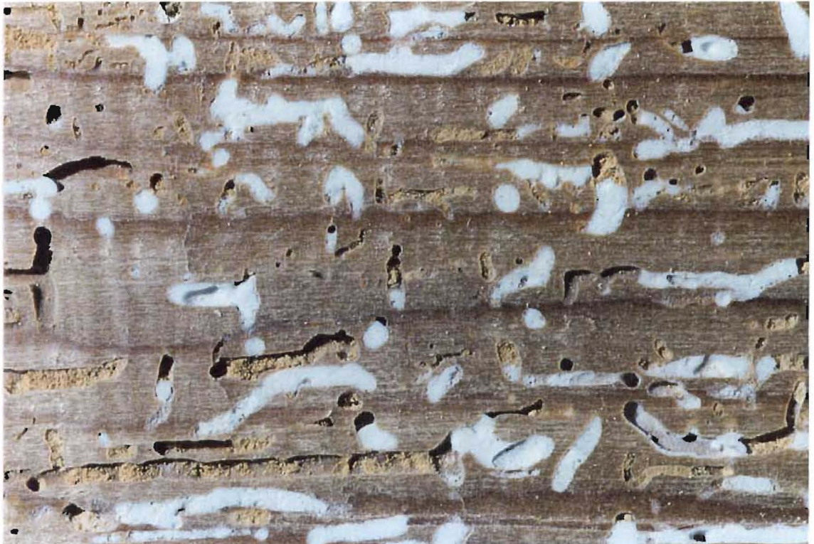
Bild 7: Füllung und Stabilisierung von insektenzerstörtem Holz mit einem Gemisch aus Hohlglaskugeln und Paraloid B 72
