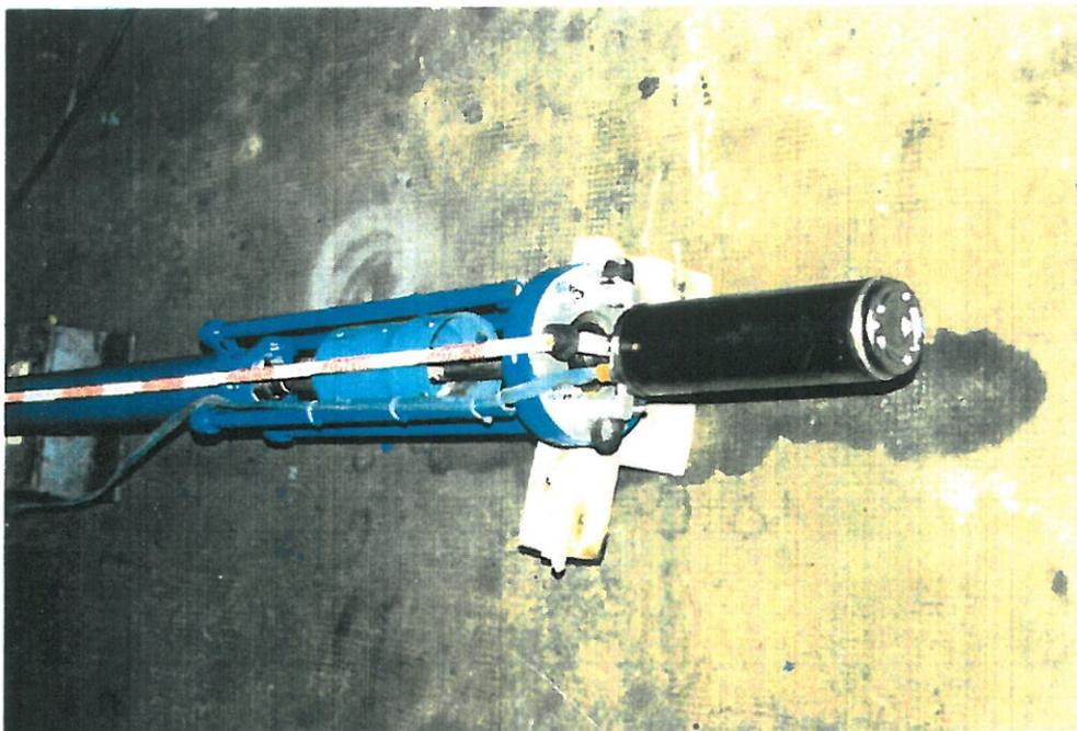
**Bild 3c: Turbobrunneneinsatz nach dem Umbau mit Unterwassermotor**
