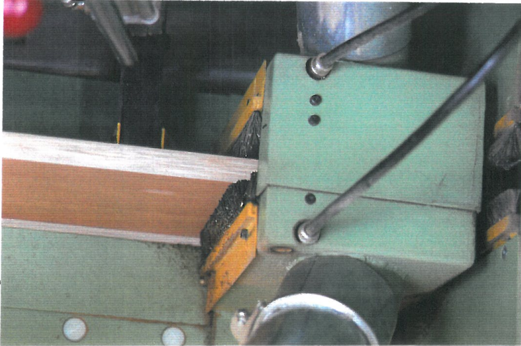
Bild 9.5.4: Absaug- und blasvorrichtung am Ende des F-Teils
