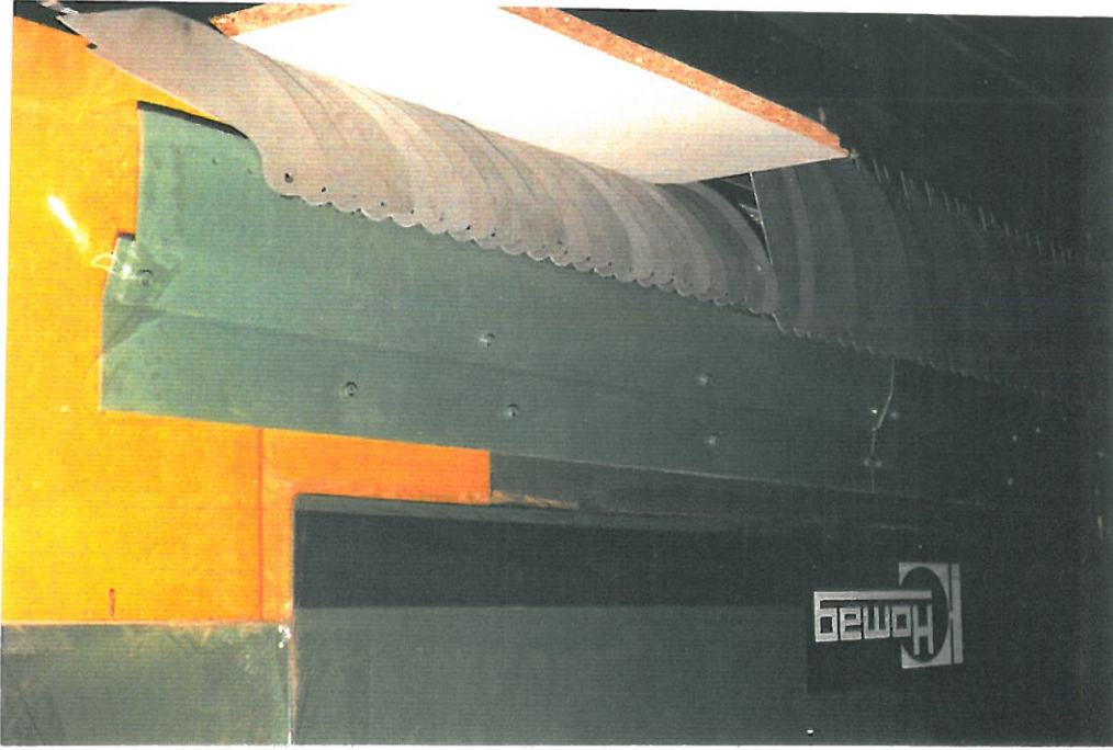
Bild 6.2.1: Feststehende Elemente mit gekrümmter Kontur und Anstellwinkel
