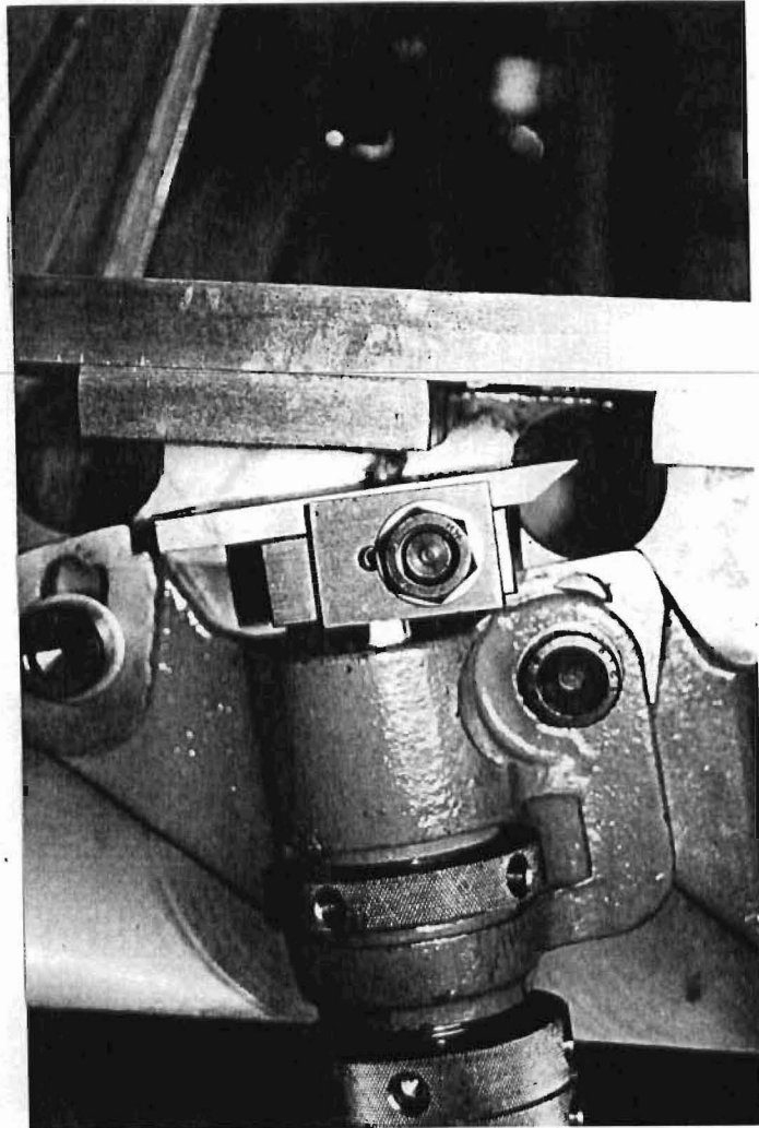
Abbildung 6: Werkzeughalter mit eingespanntem Messer; der Draht ist noch noch nicht eingespannt.
