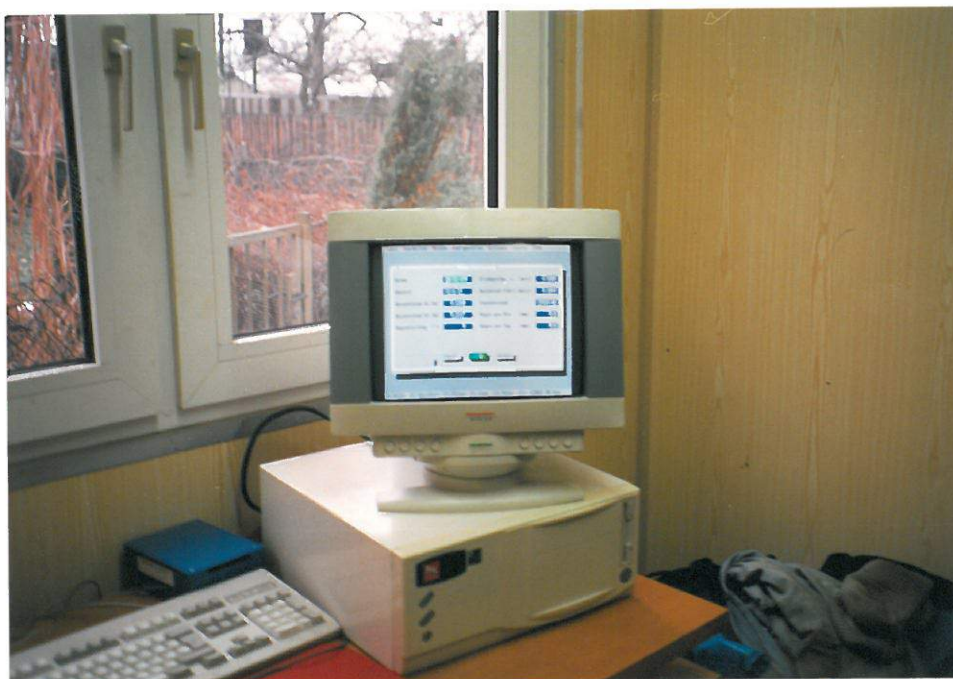
Bild 12: Online-Meßwerterfassung in Dresden-Leuben (Wasserstand, Fließgeschwindigkeit, Bogenstellwinkel, Niederschlagshöhe)
