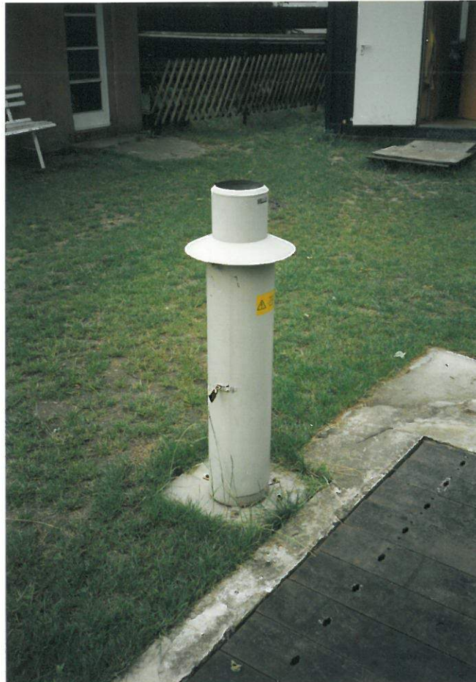
Bild 11: Regenschreiber nach dem Wippenprinzip
