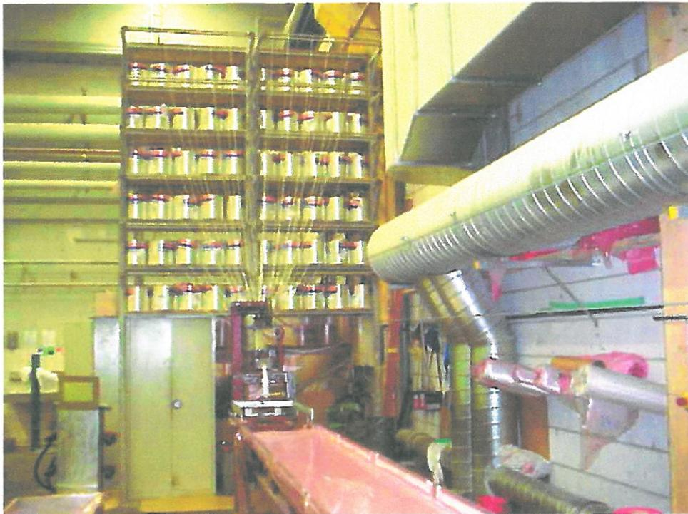
Rovingziehanlage mit Rovingregal und Tränkbecken
