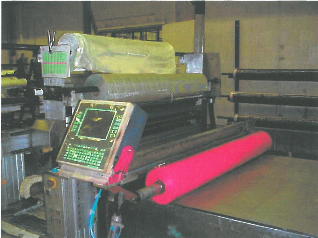
Laminiermaschine ES Laminatic mit mehrfach Geweberollenhalter, Folienabwickelvorrichtung und Ablegetisch für getränktes Gewebe
