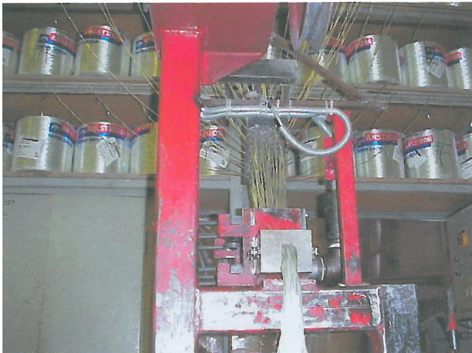
Rovings werden oben zugeführt und im Becken getränkt, dann durch die Düse kalibriert.
