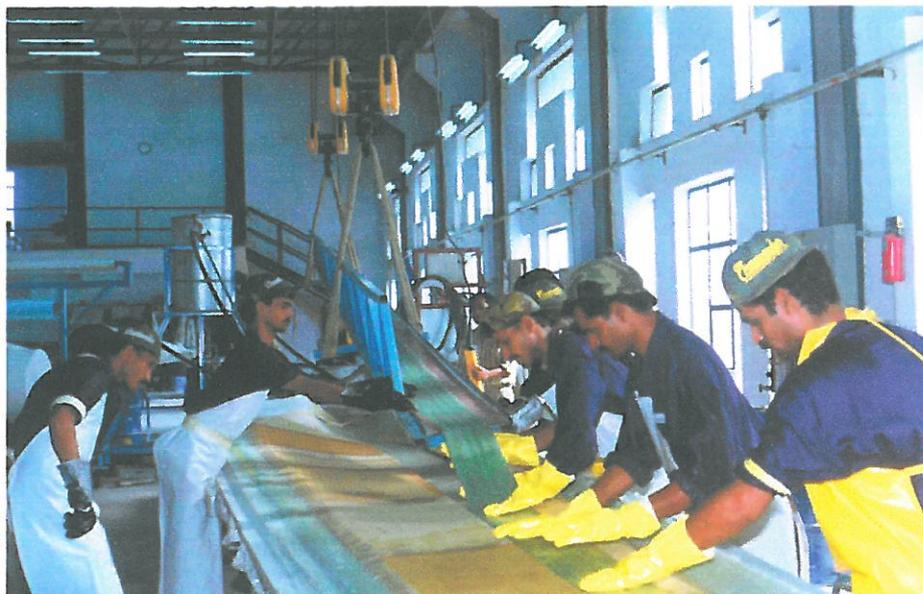
Rovingtransfer mittels einer „Gurtrutsche“
