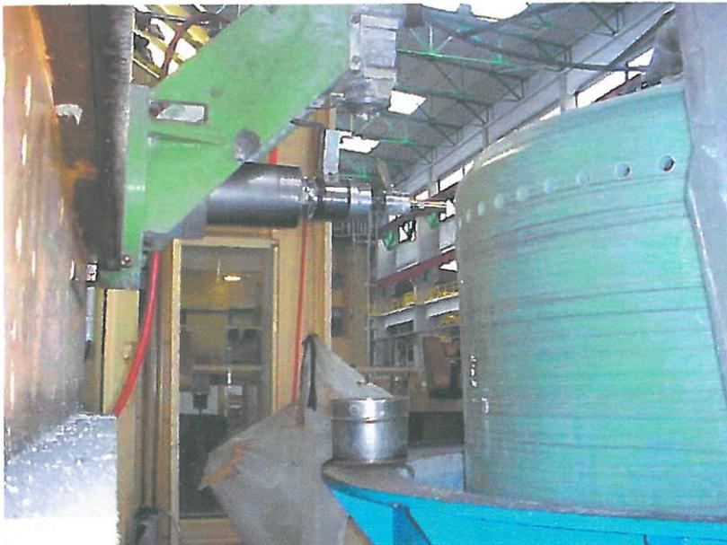
Automatische Bearbeitung separat gefertigter Flansche auf einer CNC Anlage
